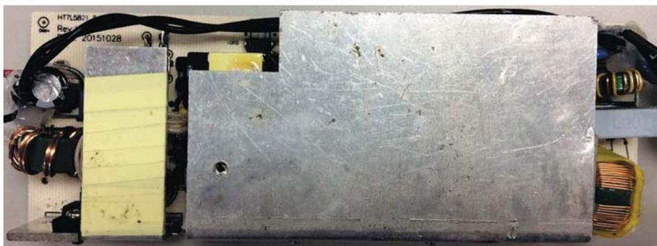
Рис. 9. Внешний вид платы драйвера со стороны крупных деталей и экрана
